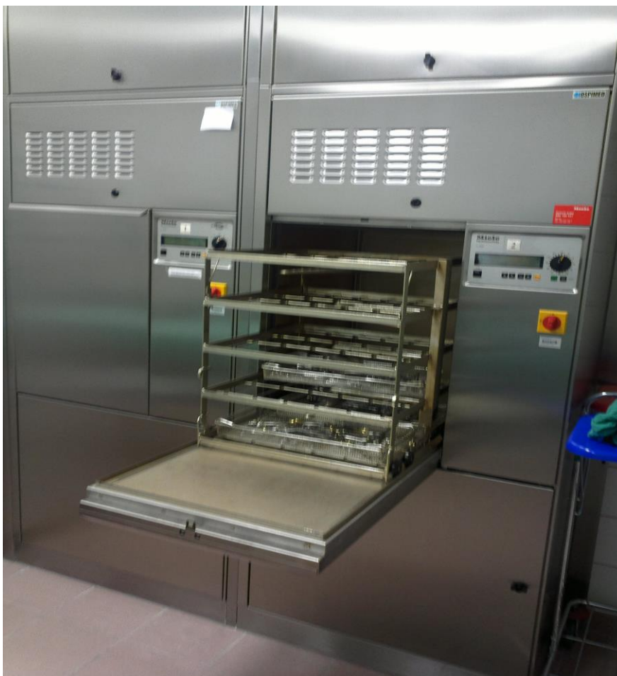
Myčka nástrojů, pomůcek – úsek centrální sterilizace ve FN Olomouc
