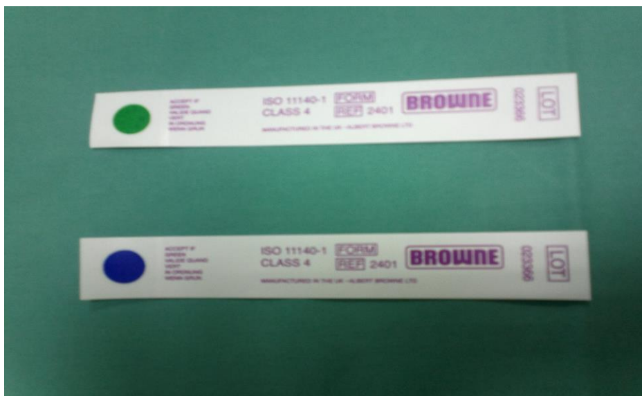
Chemický test ke kontrole sterility formaldehydem – horní proužek před, spodní proužek po sterilizaci (modré zbarvení kolečka)
