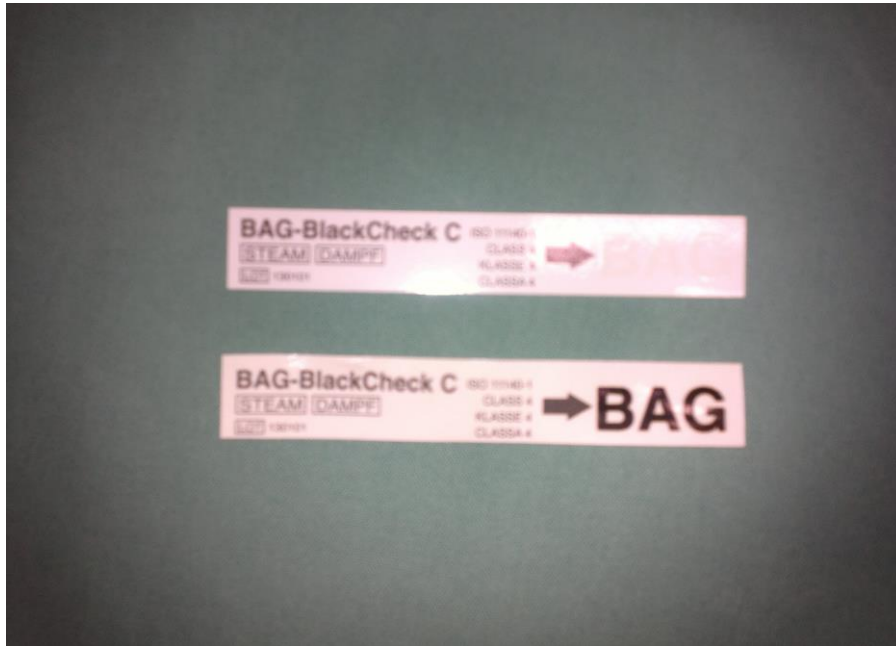
Chemický test zkoušky sterility autoklávem – horní proužek před, spodní proužek po sterilizaci (černé zbarvení BAG)
